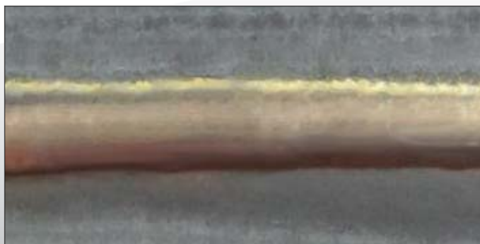
ПАЙКА-СВАРКА ПРИ ПОМОЩИ ПРОВОЛОКИ CuSi 3 BRAZING WITH CuSi 3 WIRE
