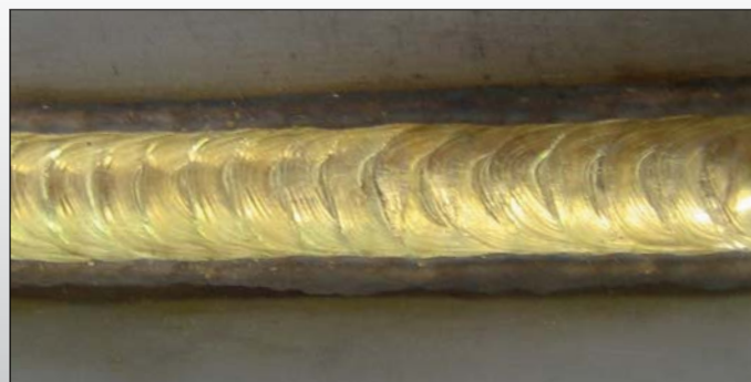
ПАЙКА-СВАРКА ПРИ ПОМОЩИ ПРОВОЛОКИ CuAl 8 BRAZING WITH CuAl 8 WIRE
