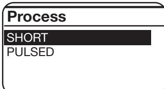
Para seleccionar ou confirmar o tipo de soldadura, é necessário, por meio do botão **B**, seleccionar e premir, durante pelo menos 2 segundos, em **Short** ou **Pulsed**.
