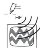
• La haute fréquence (HF) peut interférer avec la radionavigation, les services de sécurité, les ordinateurs, et en général avec les équipements de communication
