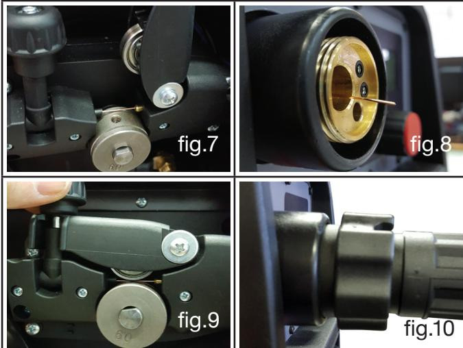
N.B.: Durante a sequência de montagem, a máquina de soldar deve estar desligada para evitar que o rolo do motor em movimento possa criar perigo para o operador.
