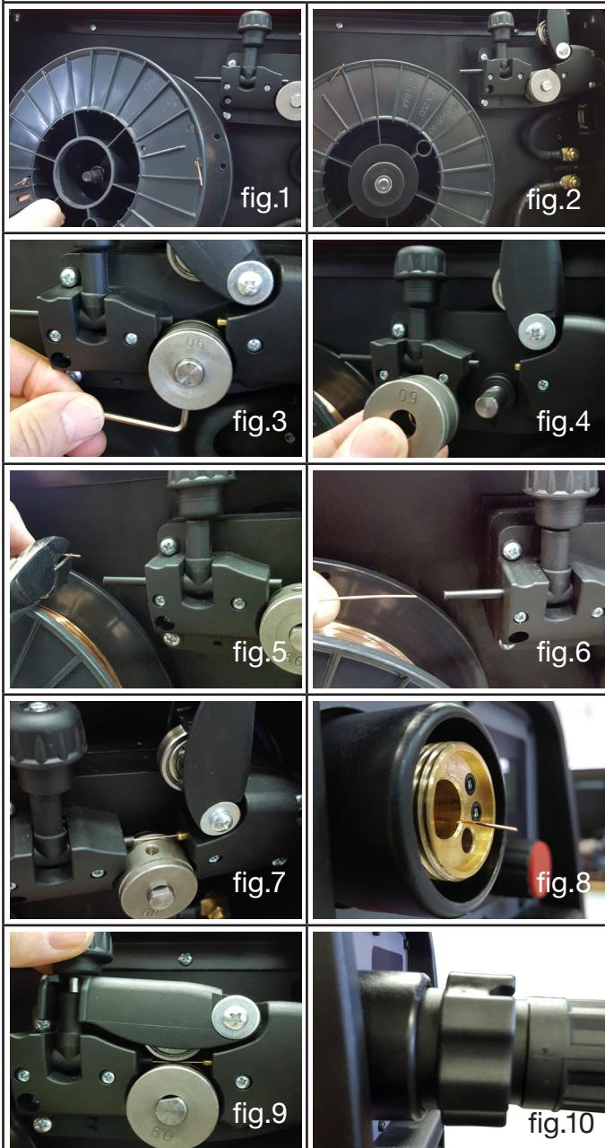
NB. Durante la sequenza di montaggio la saldatrice deve rimanere spenta per evitare che il rullo del motore in movimento possa creare pericolo per l'operatore.
