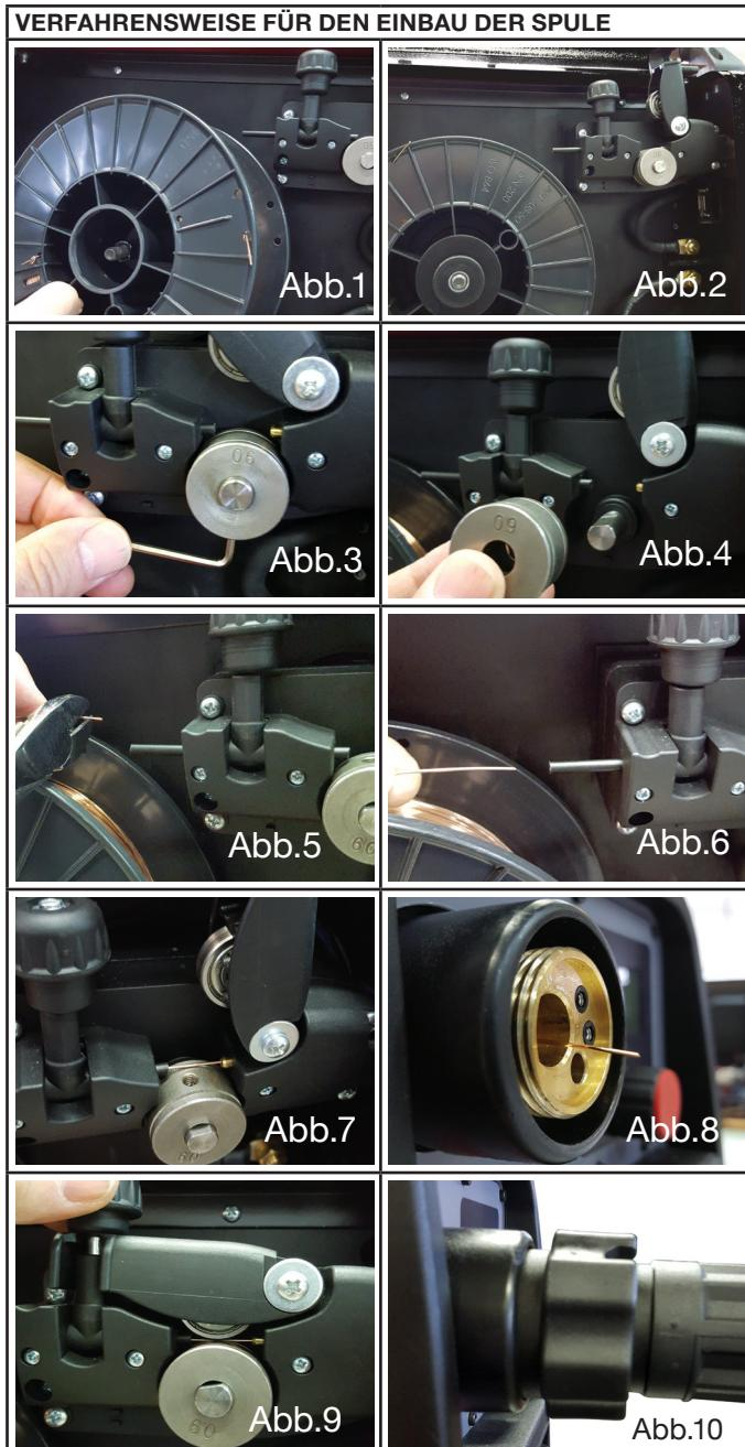
HINWEIS: Die Schweißmaschine muss während des Einbaus ausgeschaltet sein, um eine Verletzungsgefahr durch die Drehung der Rolle des Motors zu verhindern.
