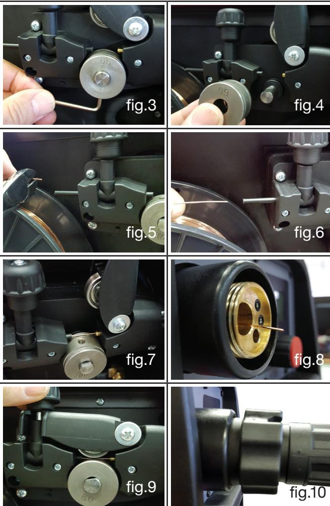
**NOTA:** Durante la secuencia de montaje la soldadora debe permanecer apagada para evitar que el rodillo del motor en movimiento pueda crear peligro para el operador.
