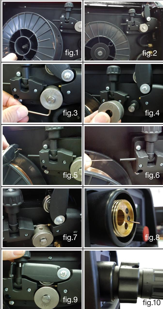
NB. Houd tijdens de montage het lasapparaat uitgeschakeld, om te vermijden dat de rol van de motor in beweging de bediener in gevaar kan brengen.
