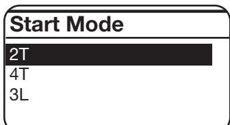
Tila **3L**, suositellaan erityisesti alumiinin hitsaukseen. Käytössä on 3 hitsausvirtaa, jotka otetaan käyttöön polttimen painikkeella. Virtojen ja virrannousuajan asetus on seuraava:
