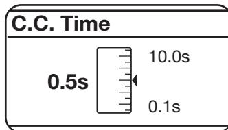
Zum Aufrufen der Funktion muss man sie mit dem Regler **B** markieren und den Regler kürzer als 2 Sekunden niederdrücken. Auf dem Display **A** erscheint dann der Einstellbalken zum Ändern des Werts. Zum Bestätigen den Regler **B** mindestens 2 Sekunden niederdrücken.
