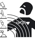
· A corrente eléctrica que atravessa qualquer condutor produz campos electromagnéticos (EMF). A corrente de soldadura, ou de corte, gera campos electromagnéticos em redor dos cabos e dos geradores.
