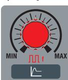
En soldadura **MMA** regula el tiempo, expresado en centésimos de segundo, de la corriente de "hot-start" ; en práctica regula una sobrecorriente que tiene la función de mejorar los encendidos. En soldadura **TIG continuo** no ejecuta ninguna regulación.
