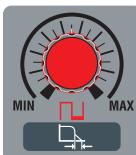
Bij **MMA-lassen** regelt deze knop het percentage van de "arc-force" -stroom; in feite regelt die een stroom die de overdracht van de elektrode bepaalt.
