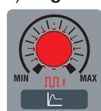
Beim Elektrodenschweißen (**MMA**) dient er zum Einstellen der Zeit in Hundertstelsekunden des Anfangsstroms ("Hot Start"). Er regelt praktisch einen Überstrom, der das Zünden optimiert. Beim **WIG-Konstantstromschweißen** hat er keine Wirkung.
