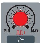
Ved **MMA** svejsning benyttes håndtaget til indstilling af tidsrummet (udtrykt i 1/100 sekund) for strømmen til Hot-Start . Håndtaget benyttes i principippet til indstilling af en overstrøm, der har til formål at forbedre tændingerne. Håndtaget udfører ingen indstilling i forbindelse med konstant **TIG** svejsning.
