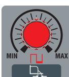
Em soldadura **MMA** regula a percentagem da corrente de “arc-force” ; na prática regula uma corrente que determina a transferência do eléctrodo.
