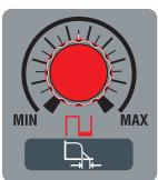
Beim Elektrodenschweißen (**MMA**) dient er zum Einstellen des Prozentsatzes des Stroms für die Stromnachregelung ("Arc Force") . Er regelt den Strom beim Hereindrücken der Elektrode in das Schweißbad.
