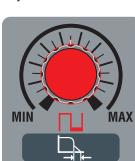
Puikkohitsauksessa säädetään tällä nupilla valokaaren karheutta ” arc.force” ; säätö vaikuttaa lisääineen siirtymiseen. Tällä säädöllä ei ole vaikutusta jatkuvassa TIG-hitsautoiminnossa.
