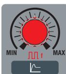
Em soldadura **MMA** regula o tempo, indicado em centésimos de segundo, da corrente de “hot-start” ; na prática regula uma sobrecarga de corrente que tem a função de melhorar o acendimento. Em soldadura **TIG contínuo** não executa nenhuma regulação.
