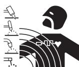
• Strøm, der løber igennem en leder, skaber elektromagnetiske felter (EMF). Svejse- og skærestørn skaber elektromagnetiske felter omkring kabler og strømkilder.
