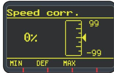
Girando de una posición la manecilla **M1** el display **D3** visualiza la pantalla relativa a a corrección de la velocidad del hilo.
