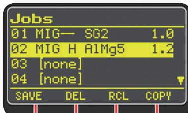
Le numéro du programme «Job», le procédé de soudure et le diamètre du fil sont visualisés sur l'afficheur. Quand un «Job» a été mémorisé, dans la partie inférieure de l'afficheur des sigles correspondant aux touches **T6**, **T7**, **T8** et **T9** sont visualisés :
