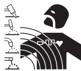
A corrente eléctrica que atravessa qualquer condutor produz campos electromagnéticos (EMF). A corrente de soldadura, ou de corte, gera campos electromagnéticos em redor dos cabos e dos geradores.
