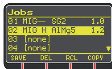
Die Nummer des Programms "Job", das Schweißverfahren und der Drahdurchmesser werden auf dem Display angezeigt.
