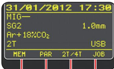
Dans la partie inférieure de l'afficheur, les sigles (MEM, PAR, 2T/4T et JOB) sélectionnables avec les touches fonction **T6, T7, T8, T9** (voir par.8) sont visualisés.
