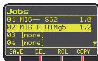
Il numero del programma "Job", il processo di saldatura, e il diametro del filo vengono visualizzati sul display.
