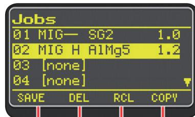
Het nummer van het "Job" programma, het lasproces, en de diameter van de draad worden op het display weergegeven.
