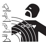
· La corrente elettrica che attraversa qualsiasi conduttore produce dei campi elettromagnetici (EMF). La corrente di saldatura o di taglio genera campi elettromagnetici attorno ai cavi e ai generatori.
