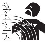
· A corrente eléctrica que atravessa qualquer condutor produz campos electromagnéticos (EMF). A corrente de soldadura, ou de corte, gera campos electromagnéticos em redor dos cabos e dos geradores.
