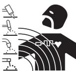
Der elektrische Strom, der durch einen beliebigen Leiter fließt, erzeugt elektromagnetische Felder (EMF). Der Schweiß- oder Schneidstrom erzeugt elektromagnetische Felder um die Kabel und die Stromquellen.
