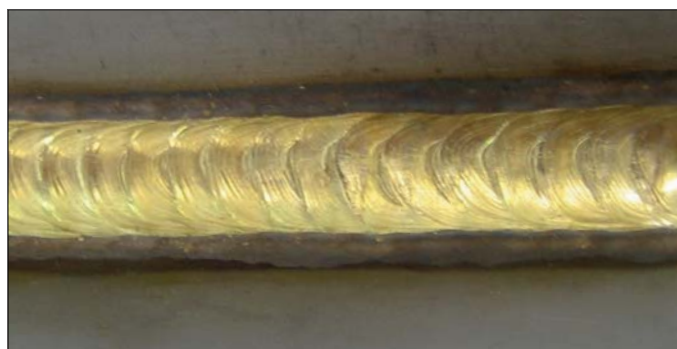
BRASATURA CON FILO CuAl 8 BRAZING WITH CuAl 8 WIRE
