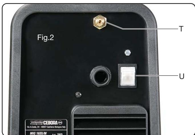
T – Raccord avec tuyau gaz.
